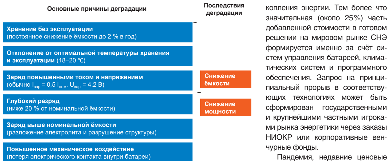
Рисунок 5. Причины и последствия деградации в электрохимических накопителях 4
